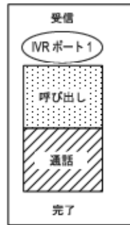
図 86: IVR ポートに対する直接インバウンド通話 —IRF、完了
